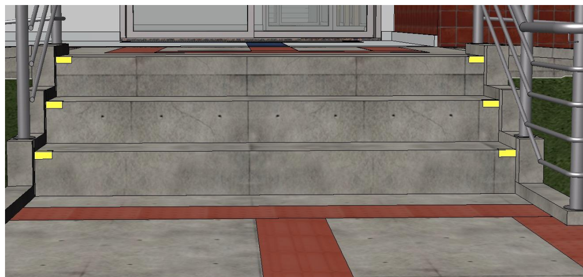
Perspectiva - Sinalização de escadas
