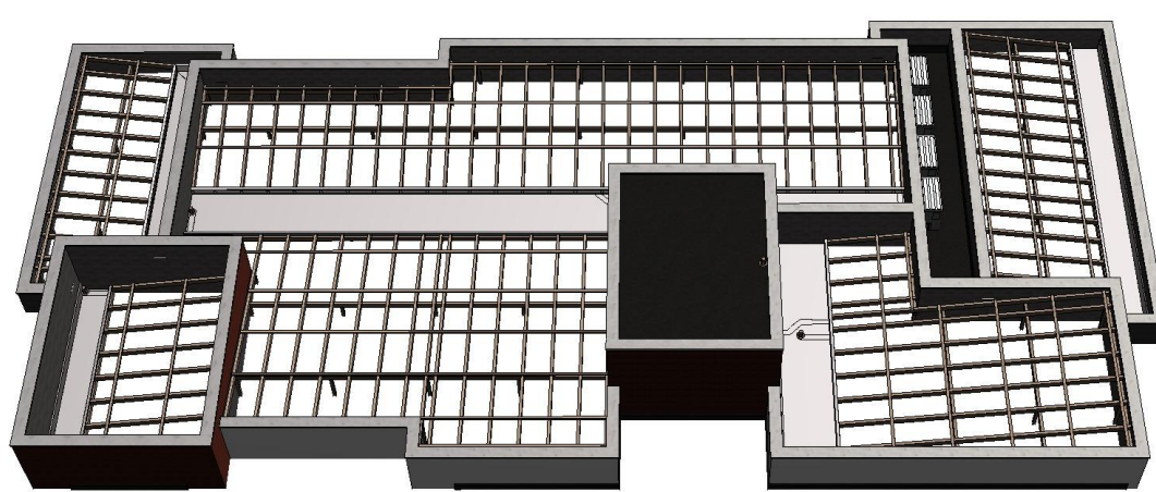
Perspectiva - Madeiramento telhado
